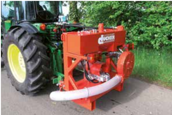
Hydraulikanlæg i trepunkt bagpå (delt konstruktion), kan fås med blæser
