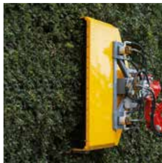
HS 130 HR Rotor Hækkeklipper Arbejdsbredde: 1300 mm Klippetykkelse: op til 25 mm Vægt: 165 kg
