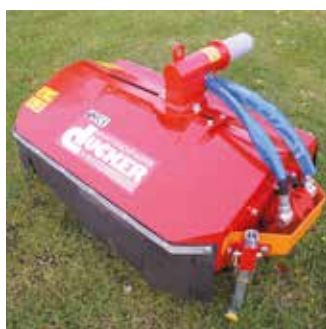
MKL 10 Slagleklippehoved Arbejdsbredde: 1000 mm Rotoromdrejningstal: 2700 o./min. Vægt: 180 kg
