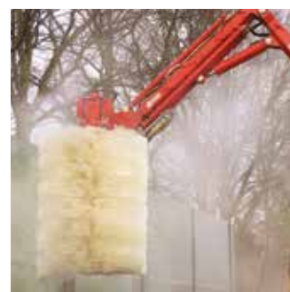
SWA 900 Skiltevaskeanlæg Børstebredde: 900 mm Børsteomdrejningstal: 250 o./min. Vægt: 155 kg
